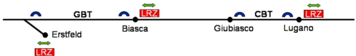
In den Portalbereichen des GBT sind je eine Interventionsstelle respektive eine Notausstiegsstelle (NAS) vorgesehen, die eine Intervention bei havarierten Güterzügen ermöglichen soll, bevor diese in den GBT hineinfahren oder wenn sie aus dem GBT herausfahren.
