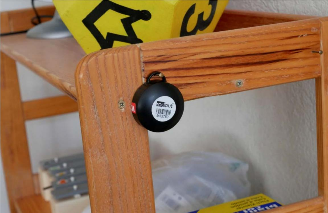
Foto: Radon-Dosimeter für die Messung im Schulzimmer
