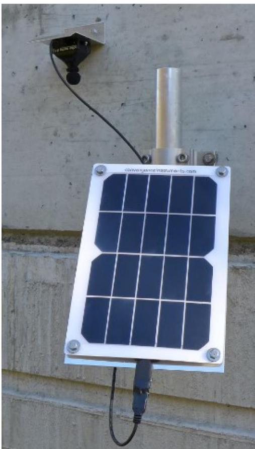
Foto: Lärmmessgerät mit Solarpanel
