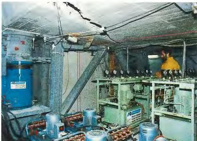
Bild 9. Hydraulikaggregate und horizontale Pressenfixierung (L. Buscarlet)
