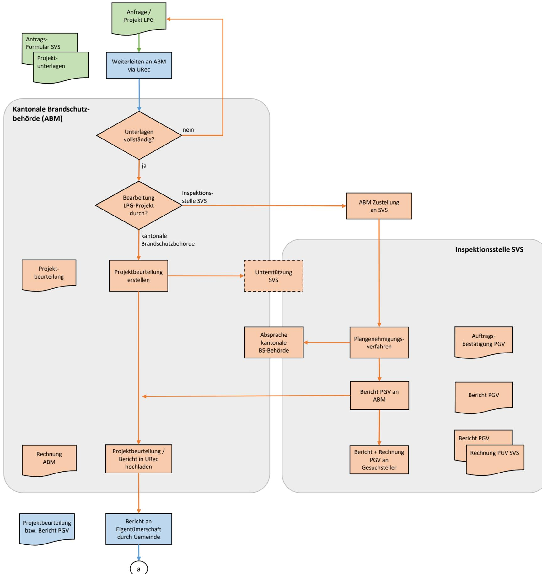
Dieser Prozess gilt für Projekte mit Flüssiggas LPG (Gaslager, Gasleitungen, Gasverbraucher) und sinngemäss für alle Projekte mit brennbaren und/oder technischen Gasen. (z.B. LPG-Tankstellen für Fahrzeuge, Tanklager für technische Gase, H<sup>2</sup>-Produktionsanlagen und Tankstellen).
