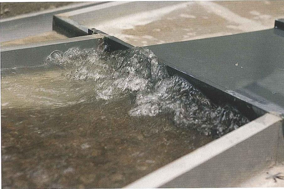
**Bild 4. Druckbrücke der SBB-NEAT über den Schächen, Abfluss von 225 m<sup>3</sup>/s im Modell (Quelle VAW).**
