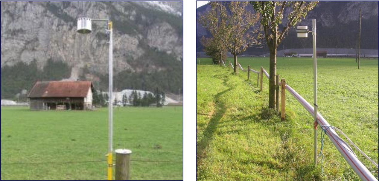
**Abbildung 8:** Beispiel eines NH<sub>3</sub>- (links) und eines NO<sub>2</sub>-Passivsammlers (rechts)
