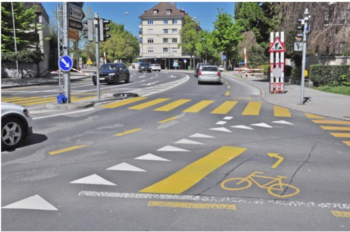
Abbildung 27: Indirektes Linksabbiegen (signalisationstechnisch)
