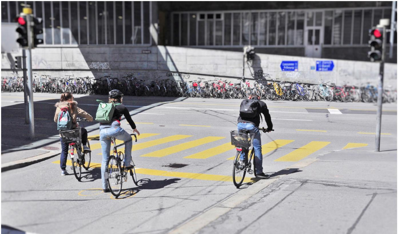
Abbildung 26: Ausgeweiteter Radstreifen
