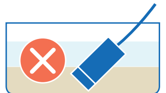
Abbildung 2: Pumpenmontage, Pumpe darf nicht im Schlamm liegen
