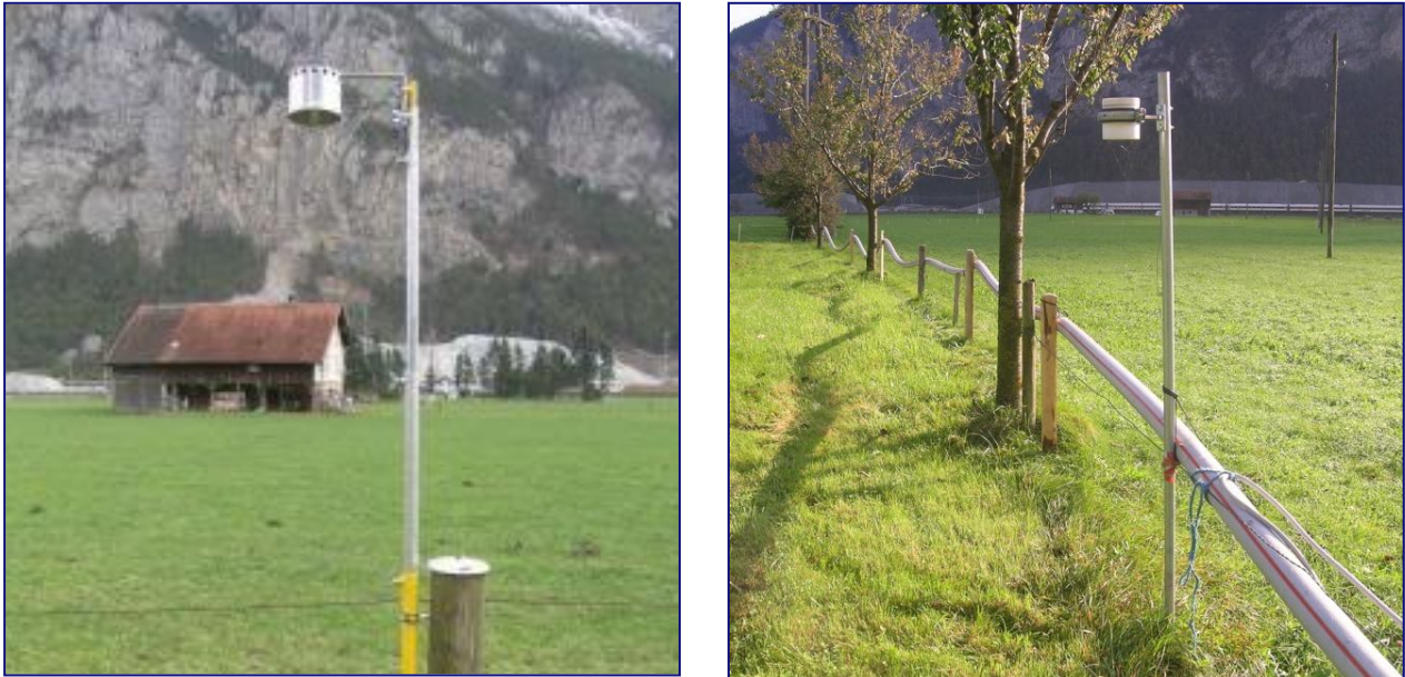
Abbildung 8: Beispiel eines \text{NH}_3 - (links) und eines \text{NO}_2 -Passivsammlers (rechts)
