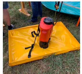
Mobile Blache mit angehobenem Rand für das Befüllen kleinerer Spritz- und Sprühgeräte
