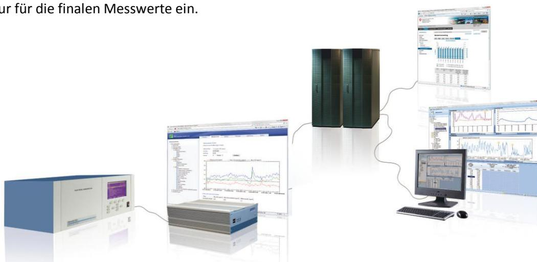
Abbildung 15 Datentransfer vom Messgerät über den Messstationsrechner Daisy in die AirMo
