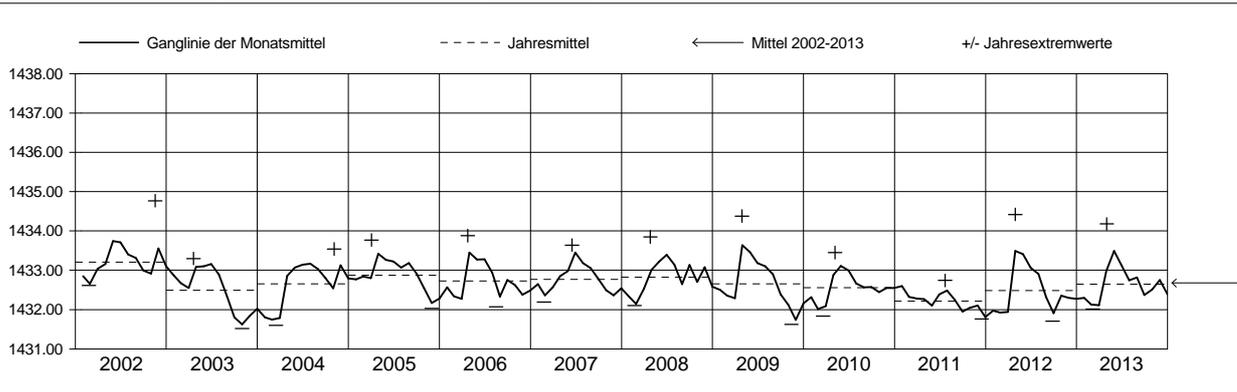
Bemerkung: 2009 bis 2012 grossräumige Grundwasserabsenkung aufgrund einer Baustelle Auswertung: CSD
