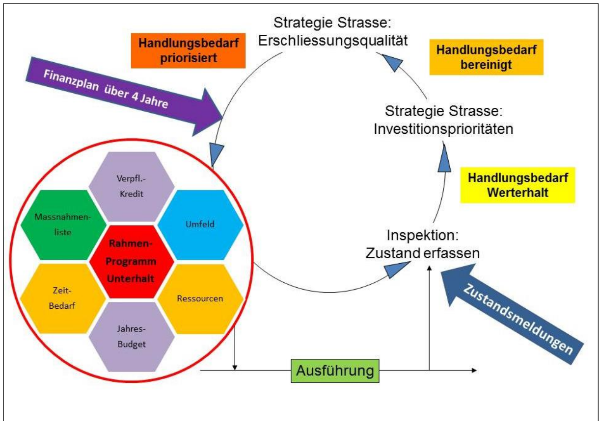
Abbildung 2: Kreislauf baulicher Unterhalt der Kantonsstrassen
