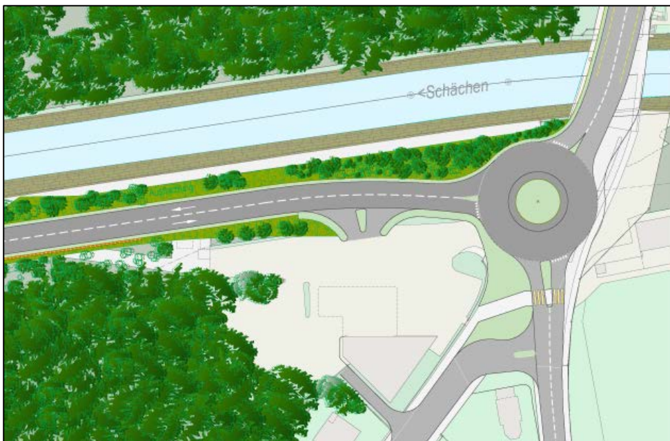
Abb. 15: Der Knoten Schächen wird umgestaltet, beispielsweise mit einem neuen Kreisel. Dieser Lösungsansatz schont die umliegenden Liegenschaften sowie den Fussballplatz des FC Schattdorf.
