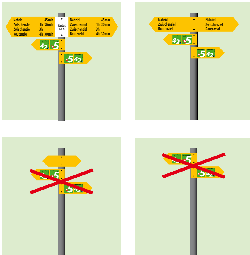
Abb. 18 Montagehinweise für Wegweiser mit Routenfeldern.
