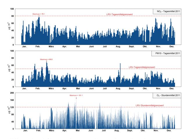
Abbildung 21: Jahresverlauf der PM10- und NO<sub>2</sub>-Tagesmittelwerte sowie der O<sub>3</sub>-Stundenmittelwerte von 2011 der Station A2 Uri
